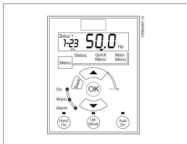
Ilustração 4.2: LCP 11 sem potenciômetro
